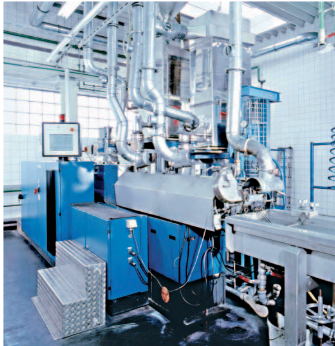
Abb. 1: Mit einem ZSK MEGAvolume compact lassen sich vor allem großvolumige und temperaturempfindliche Pigmente verarbeiten, weil die Scherung relativ gering ist.
