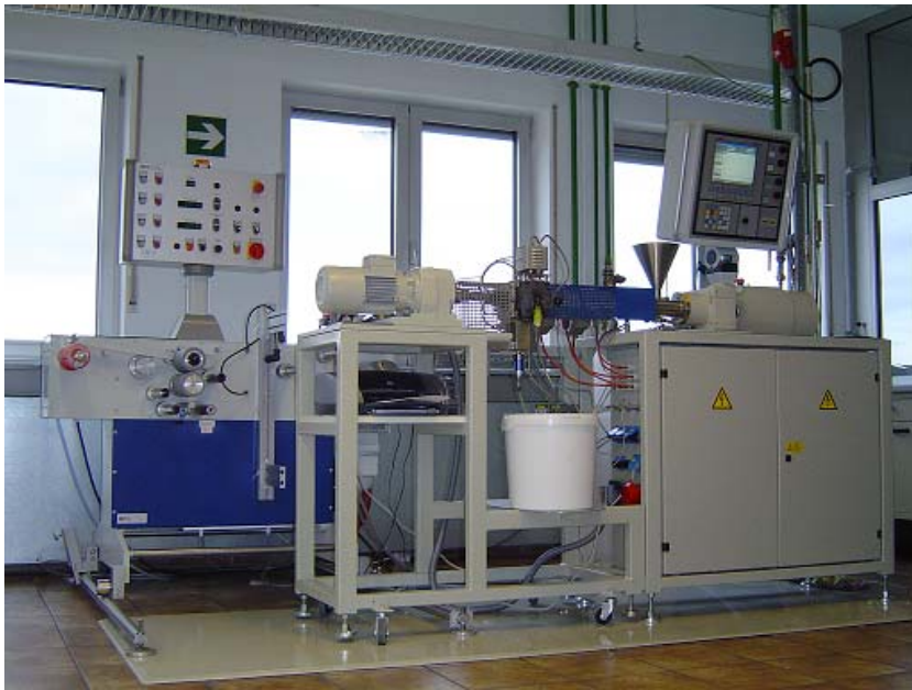
Bild 2: Als einer der ersten Kunststoffverarbeiter setzt die Treffert-Gruppe Polymer-Technologie einen EN-13900-5-konformen Extruder ein.
