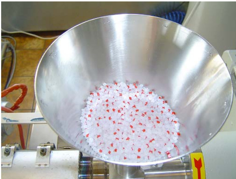
Bild 1: Druckfiltertest nach EN 13900-5: Über den Druckanstieg einer definierten Menge bei der Extrusion kann auf die Dispergierung der Pigmente und auf Verunreinigungen durch Grobpartikel, Agglomerate oder Rußanteile geschlossen werden.
